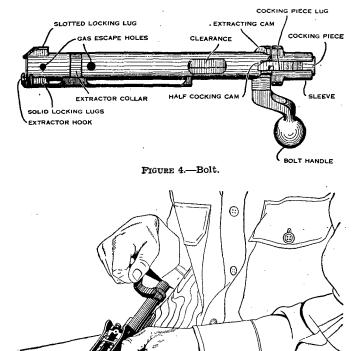
FIGURE 5.—Removing bolt.
